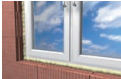
Juntas en instalación de aberturas
